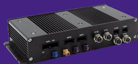
Ein für Straßenfahrzeuge zertifiziertes IoT-Gateway für öffentliche Verkehrsmittel und Straßenfahrzeuge, das einen schnellen Umstieg auf ITxPT sowohl in bestehenden als auch in neuen Installationen ermöglicht.
