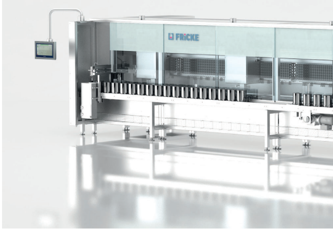
Bild 1: Dosier- und Abfüllanlage mit Edelstahl-Panel-PC © Fricke Abfülltechnik GmbH & Co. KG
